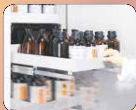
Выдвижные поддоны с механизмом блокировки в любом положении. В случае пожара ящики автоматически задвигаются внутрь шкафа, обеспечивая беспрепятственное закрытие дверей
